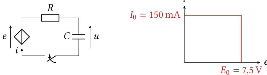
La résistance vaut  $R = 20 \Omega$  et la capacité du condensateur  $C = 50 \mu\text{F}$ . Au contraire d'un générateur de tension, la caractéristique d'une alimentation stabilisée est non-linéaire, rectiligne par morceaux, ce qui change évidemment le comportement du circuit.
